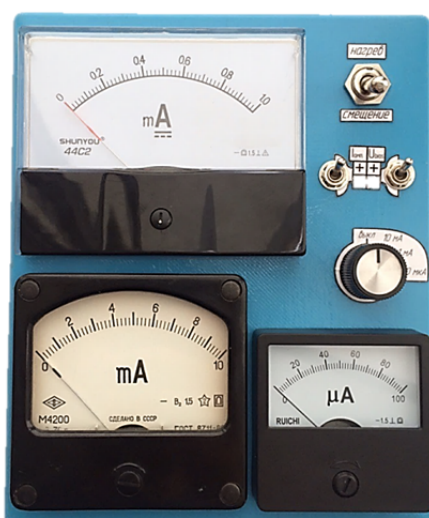
Рис. 3. Блок коммутации источника питания постоянного напряжения
