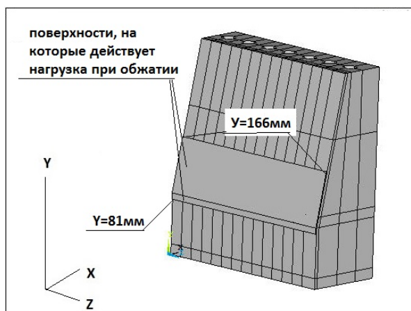
Рис. 3. Модель для расчета и характер нагружения стенки-бойка
