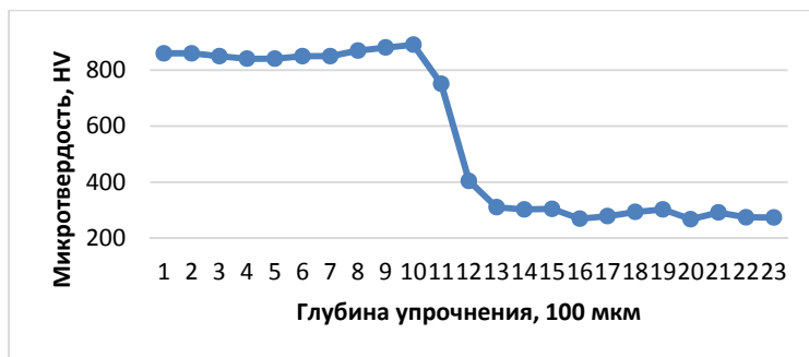
Рис. 4. Микротвердость оптимального образца, полученного при скорости обработки 25 мм/с и мощности лазерного излучения 5 кВт
