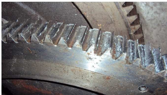
Рис. 1. Фрагмент изношенного зубчатого колеса
