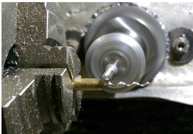
Рис. 2. Обработка винтовой поверхности с диаметром сечения 1,2 мм
