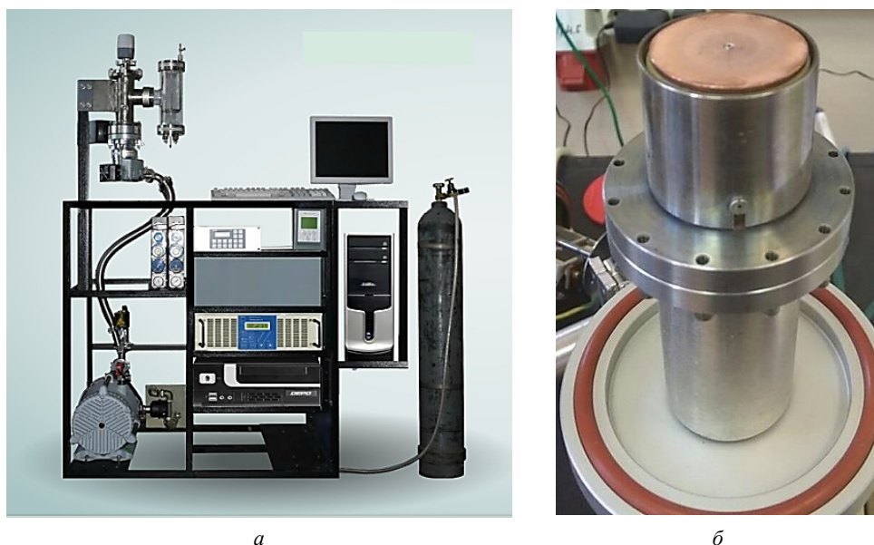
Рис. 2. Общий вид установки УВН-1М (а) и модуль магнетронного распыления (б)
