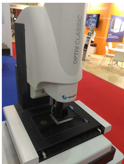
Рис. 1. Оптическая бесконтактная координатно-измерительная машина
