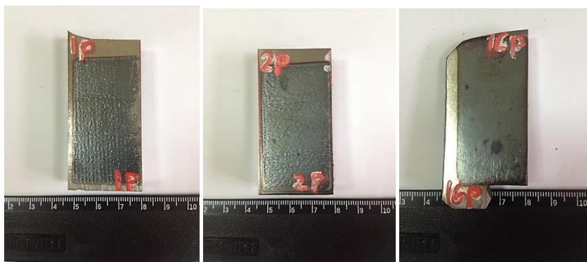
Рис. 3. Внешний вид дорожек после упрочнения волоконным лазером с использованием оптической головки 2D High-power Scanner IPG
